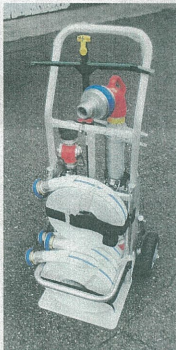
消防用ホースや筒先などをコンパクトに収納できるスタンドバイ式の初期消火器用の台車
